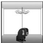
Referencia de plomada para instalación de lámparas
